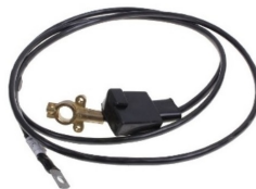
ATD85651 перемычка АКБ ГАЗ-33104 [КЛ04625ЕП] L=2700мм, S=25мм, клемма евро плюс - наконечник d=10
