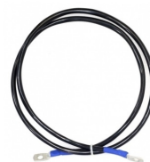
ATD83282 перемычка АКБ L=1500мм, S=25мм, наконечник-наконечник d=10мм
