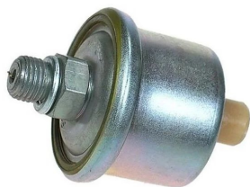
ATD54837 датчик давления масла (грибок) MA 3, ЗИЛ, Т-170 (0-10 атм.) [MM355]
