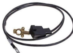
ATD85611 провод АКБ ГазельNext [A21R223724150] L=1830мм, S=35мм, клемма евро плюс - наконечник d=10
