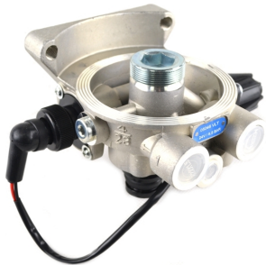
05046VLT площадка осушителя [4324101027] 8,1BAR, 24V (с обогревом) [port: 1+21=M22x1,5, 22+4=M12x1,5]
