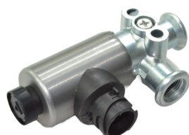
05083VLT клапан электромагнитный [4720726390] MB ACTROS/AXOR (блокировка диф-ла) (0,41A, 65V, 9.9W, 58ohM)
