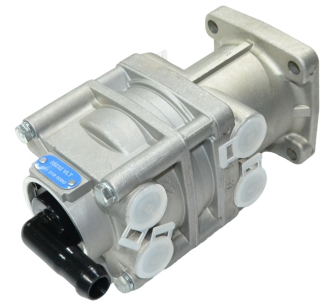
05232VLT пневмокран тормозной 2-х контурный 10 BAR/Ports:8xM16x1.5mm/2xM12x1.5mm [4613190080] MB/DAF/STEYR
