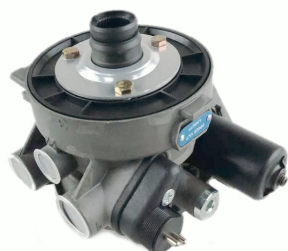
05957VLT площадка осушителя [LA8210] 10,0BAR, 24V MAN/DAF (с обогревом) [port: 1,21=M22x1,5, 22=M16x1,5]
