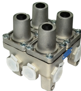
05138VLT пневмокран 4-х контурный [9347022100] MAN P1/2/3/4=7.0/5.0BAR/Port1:M22x1.5/Port :M16x1,5mm
