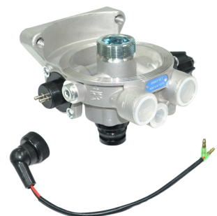
05907VLT площадка осушителя [4324101270] 8,1BAR, 12V, версия WABCO (с обог.) [port: 1+21=M22x1,5, 22=M12x1,5]
