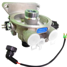
05033VLT площадка осушителя [4324101117] 13,5BAR, 24V (с обогревом) [port: 1+21=M22x1,5, 22+4=M12x1,5]
