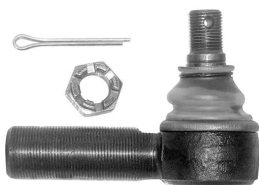
06406VLT наконечник рулевой LHT M30x1,5 / M20x1,5 L=118mm, K=23.5 [3503307135]
