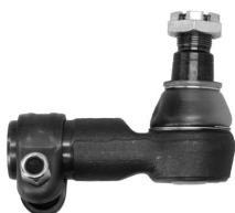
06394VLT наконечник рулевой RHT M30x1,5 внутренняя резьба / M24x1,5 L=120mm, K=30 [1603788]
