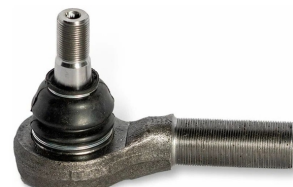
06402VLT наконечник рулевой LHT M30x1,5 / M20x1,5 ПА3 Вектор Next K=25 [C40R13-3414057]
