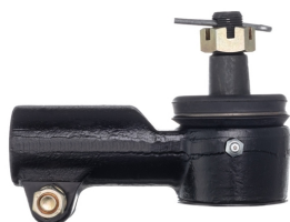
06906VLT наконечник рулевой LHT M36x1,5 внутр. резьба / M20x1,5 L=180mm ДШП=35 [43703003057]
