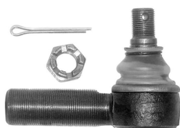
06375VLT наконечник рулевой LHT M38x1,5 / M24x1,5 L=125mm, K=30 [4688949] IVECO/MAN/RVI
