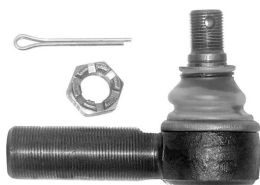
06372VLT наконечник рулевой RHT M24x1,5 / M16x1,5 L=95mm, K=20 [042480024]
