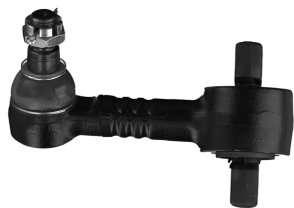
07340VLT тяга реактивная [1506924] L=150 mm, d=30mm, (с/бл 90/2*15+ шар K26 /M20*1,5), 0-изг. SCANIA
