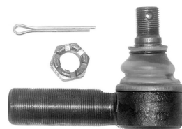
06312VLT наконечник рулевой LHT M30x1,5 / M20x1,5 L=120mm, K=28,6 [1698533] [12116 VLT]
