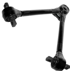
07108VLT тяга реактивная [1620436] DAF L=608mm CF75/85/XF95
