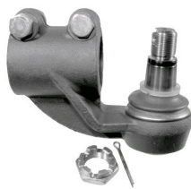
06389VLT наконечник рулевой RHT M48x1,5 / M24x1,5 L=130mm, K=30 [0067389], внутренняя резьба!
