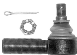
06376VLT наконечник рулевой RHT M38x1,5 / M24x1,5 L=125mm, K=30 [4688948] IVECO/MAN/RVI
