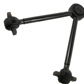
07055VLT тяга реактивная [3173293] V-образная L=660mm VOLVO FH/FM
