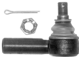
06323VLT наконечник рулевой LHT M30x1,5 / M24x1,5 L=120mm, K=31,5 [1698840] [59132 VLT]
