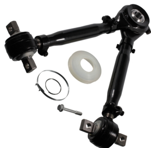
07160VLT тяга реактивная [6543500105] MB L=623 mm, d= 56 mm
