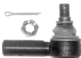
06316VLT наконечник рулевой RHT M30x1,5 / M27x1,5 L=120mm, K=32 [0014607648] [38550 VLT]
