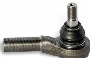
06401VLT наконечник рулевой RHT M30x1,5 / M20x1,5 ПА3 Вектор Next K=25 [C40R13-3414056]
