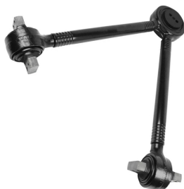
07109VLT тяга реактивная [20556586] V-образная L=685mm VOLVO F/FL
