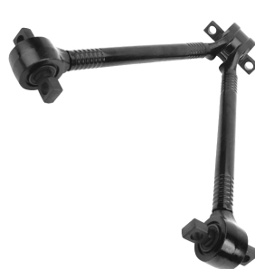
07106VLT тяга реактивная [9483502805] V-образная L=667 mm MB Actros/Axor BM 930/932/933/934
