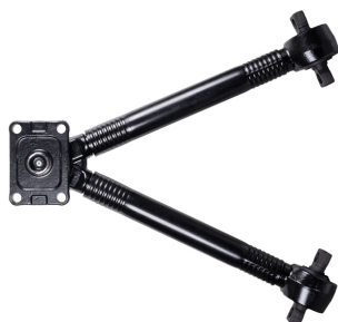
07118VLT тяга реактивная [20382314] V-образная L=649mm VOLVO FM10 (G1),FM12 (G1),FH12 (G2)
