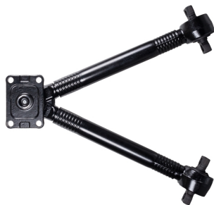
07094VLT тяга реактивная [1606552] V-образная L=641mm, d=48, 21x21/152 VOLVO F/FL/N/NL 10/12/16/F
