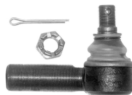
06013VLT наконечник рулевой LHT M28x1,5 / M18x1,5 L=105mm, K=22 [81953010079]
